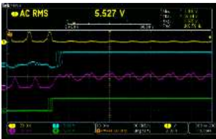
Hình 4.16. Dạng sóng đo được khi thử chạm đất pha A
